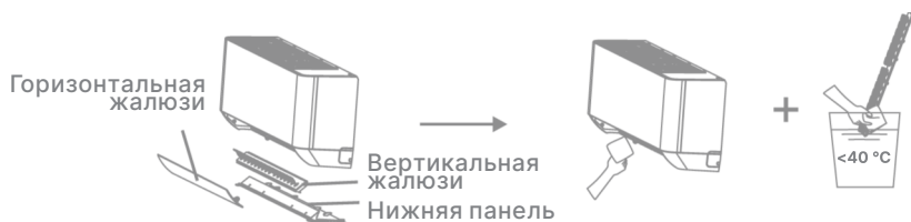
Рисунок 12 — Очистка внутренних полостей внутреннего блока
